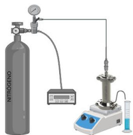
Figura 2. Esquema de prueba de antiensuciamiento
